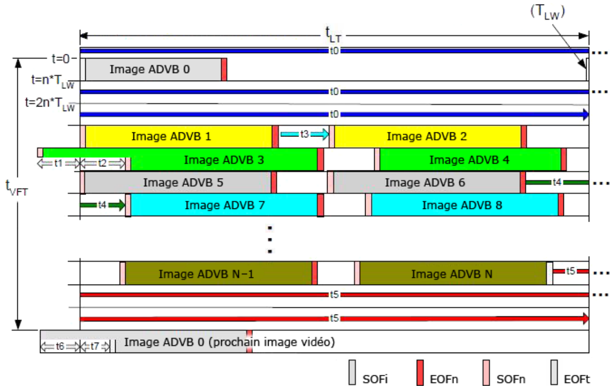
Paramètres de temporisation de l'ARINC 818 Annexe B. Exemple avec deux images FC par ligne vidéo.
